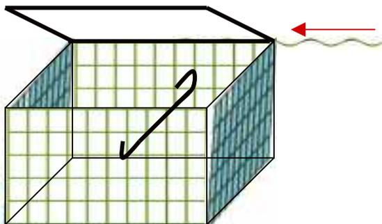
9. Verschließen Sie den Deckel mit den letzten 3 Verbindungsspiralen.
