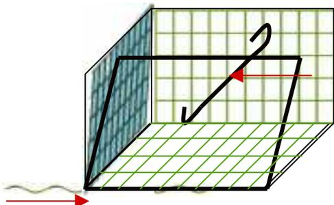
5. Befestigen Sie das 4. Element mit einer Verbindungsspirale.
